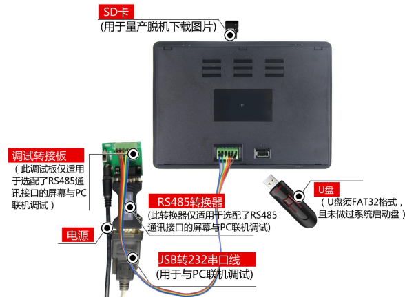
图 1-4 RS485 调试工具图
